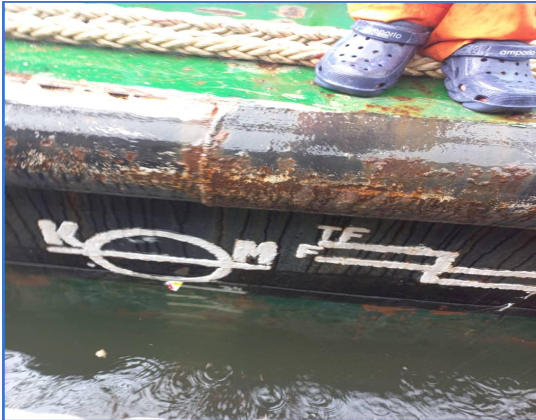
GAMBAR I – Load Line Mark sebelum belayar
